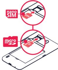
4. Si corresponde, sostenga la tarjeta microSD (se vende por separado) con los contactos metálicos orientados hacia abajo y con la esquina recortada hacia el lado superior derecho. Inserte la tarjeta en la ranura microSD.
