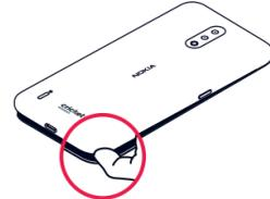
1. Con el teléfono boca abajo, inserte una uña en la ranura entre la cubierta posterior y la pantalla, doble la cubierta hasta abrirla y retírela.
